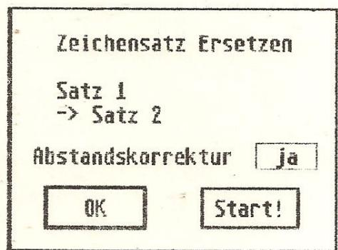
Určení čísla staré a nové znakové sady pro 3.14. Potvrzením nápisu »Ja« se při výměně změní i rozestupy mezi písmeny. Potvrzením nápisu »Start!« se výměna provede.
