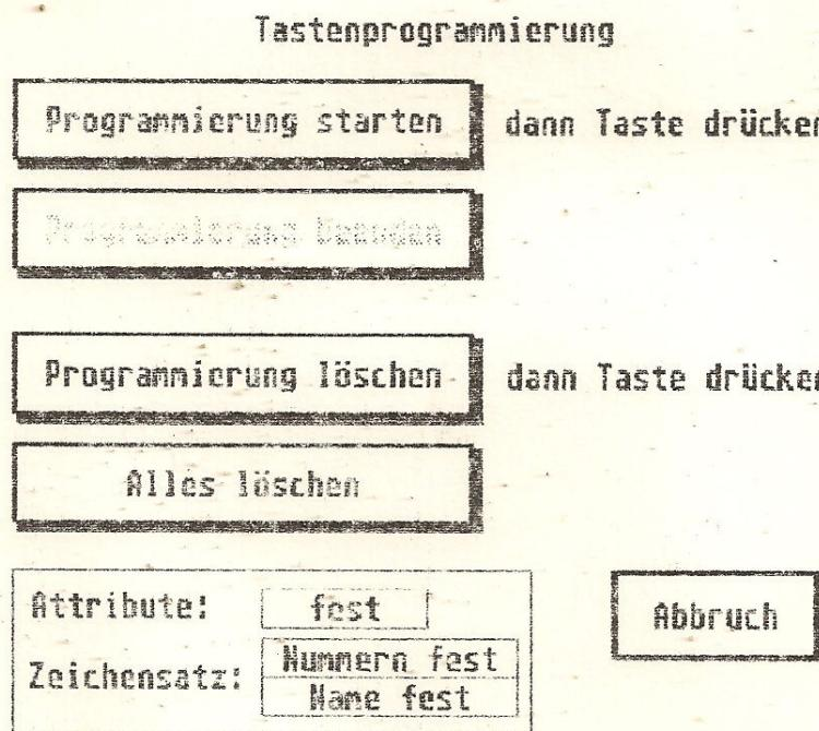
Jestliže chceme zrušit naprogramování určité klávesy, potvrďme pole Smazat program (Programmierung löschen) a stlačíme danou klávesu. Potvrzením pole Smazat všechno (Alles löschen) se zruší programy všech kláves.
